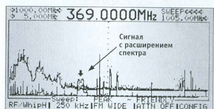
Рис. 2. Изображение сигнала с расширением спектра при развертке 5–1005 МГц
