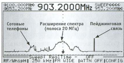
Рис. 4. Изображение ШПС-сигнала в сравнении с сигналами сотовой и пейджинговой связи
