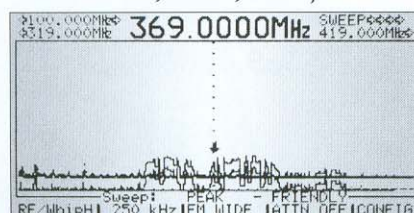
Рис. 8. Изображение импульсного радиопередатчика при развертке 970,000–1070,00 МГц (в режиме перевернутого графика разностей)
