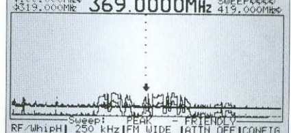
Рис. 3. Изображение сигнала с расширением спектра при развертке 319–419 МГц
